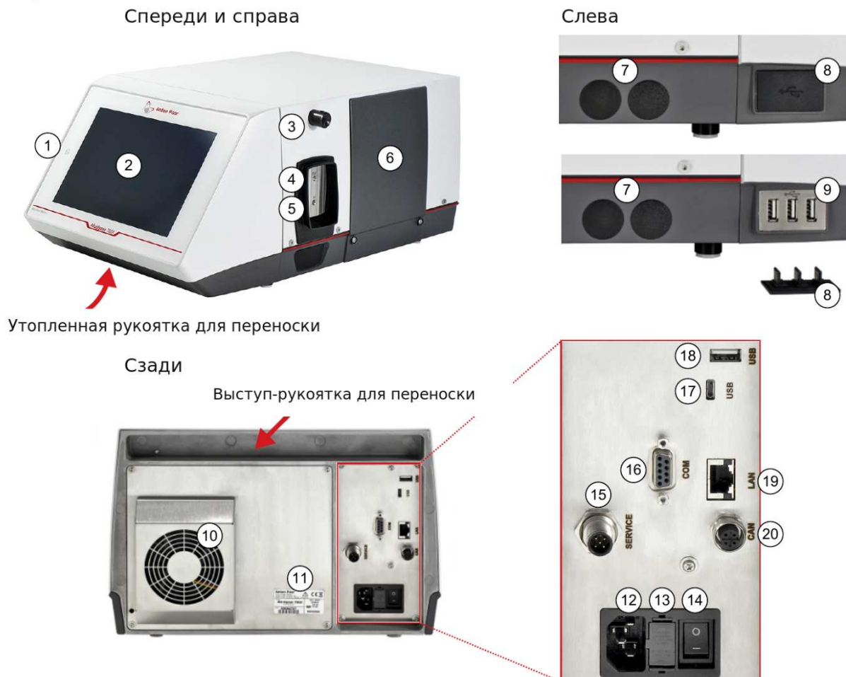
Рис. 1. Функциональные элементы Alcolyzer 5001/7001
