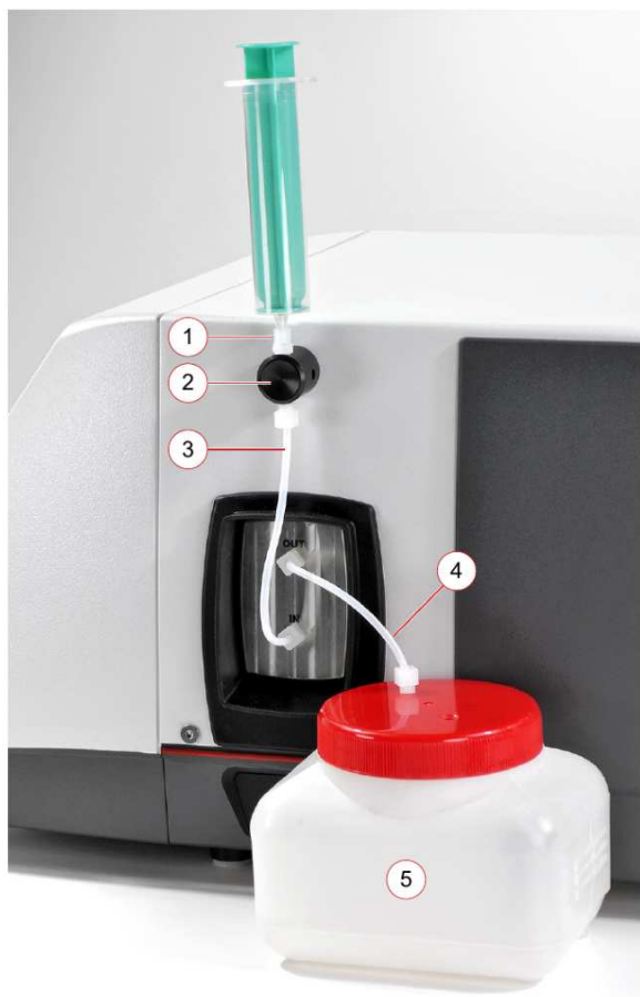
Рис. 2. Все шланги установлены; шприц подключен
